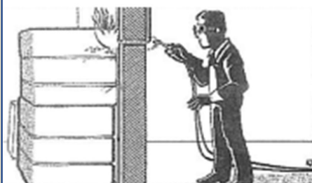
Zapłon w kontakcie z podgrzewanymi ukrytymi rurami
