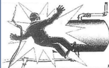
Wybuch na skutek niepełnego odgazowania
