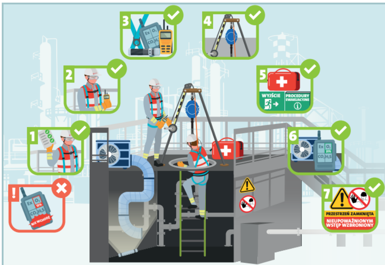
Rys. 1. Przykładowy schemat prowadzenia prac w przestrzeni (szelki bezpieczeństwa połączone z linką bezpieczeństwa i urządzeniem samohamownym, służącymi do ewakuacji i komunikowania się z osobą asekurującą).
